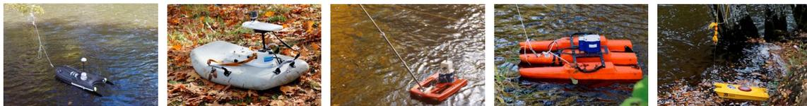
FIGURE 2.3 – Exemples d'ADCP sur différents supports flottant (de gauche à droite : M9 sur HydroBoard, M9 sur TorrentBoard, StreamPro sur Petit Catamaran, StreamPro sur Catamaran et Q-Liner).
