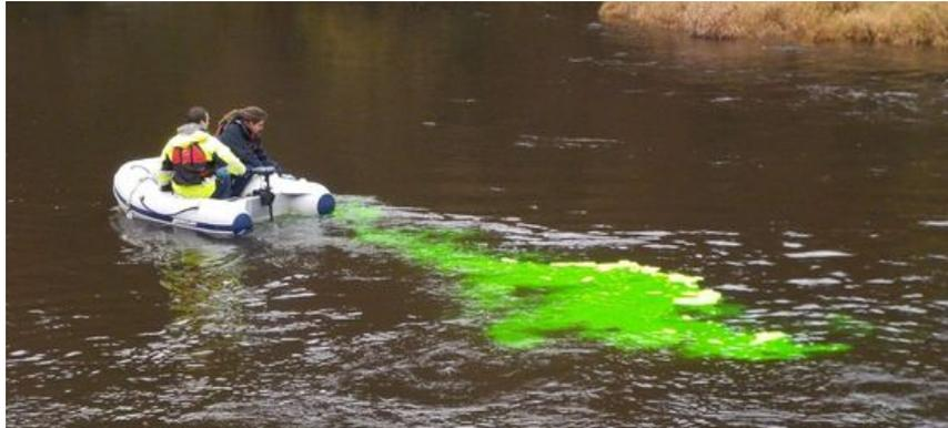
FIGURE 2.13 – Injection globale de traceur (fluorescéine) en aval du barrage de Chauvan (Source : A. Despax).
