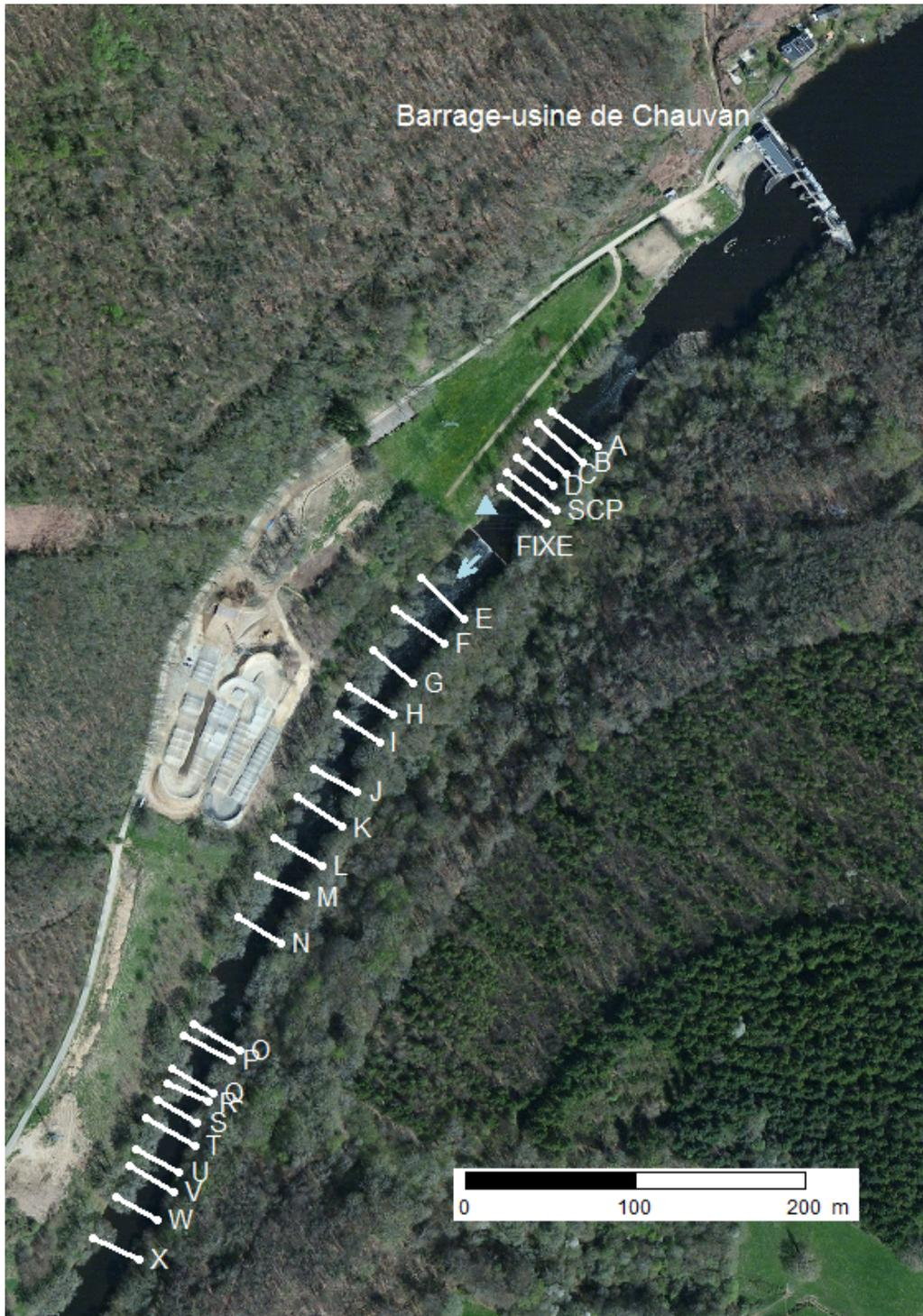
FIGURE 2.5 – Localisation des sections de mesure à partir des données GPS des appareils de mesure (données cartographiques : OpenStreetMap). La station hydrométrique EDF-DTG est représentée par un triangle bleu.
