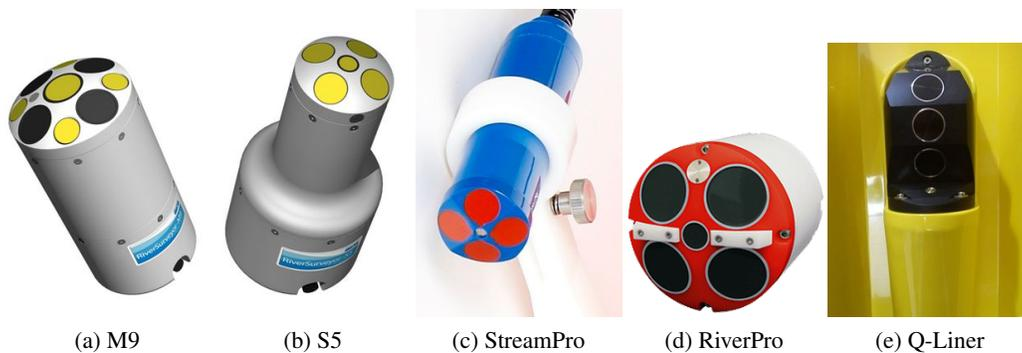
FIGURE 2.2 – Capteurs ADCP vus de dessous. (Sources : SonTek, Teledyne RDI, ASB Systems & Tecnologia y Ambiente).
