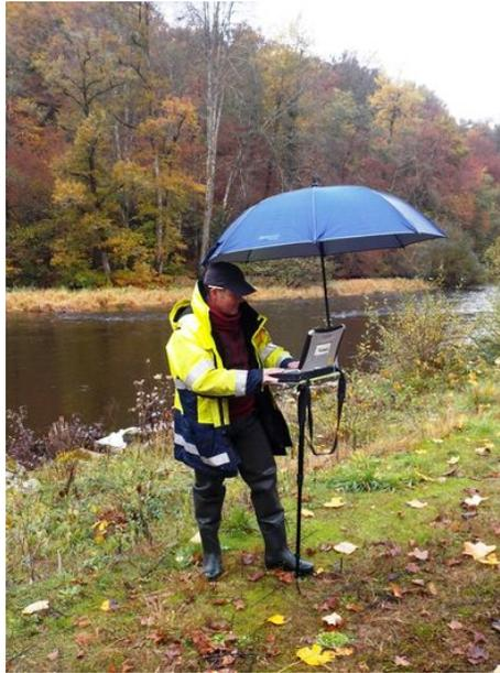
FIGURE A.2 – Pratique et ergonomie pour les déplacements, le support pour ordinateur avec porte parapluie intégré (prototype, se renseigner auprès du constructeur).
