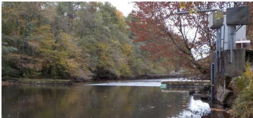
FIGURE 2.12 – Station hydrométrique EDF-DTG équipée d'un capteur limnimétrique radar VEGA (Source : A. Despax).
